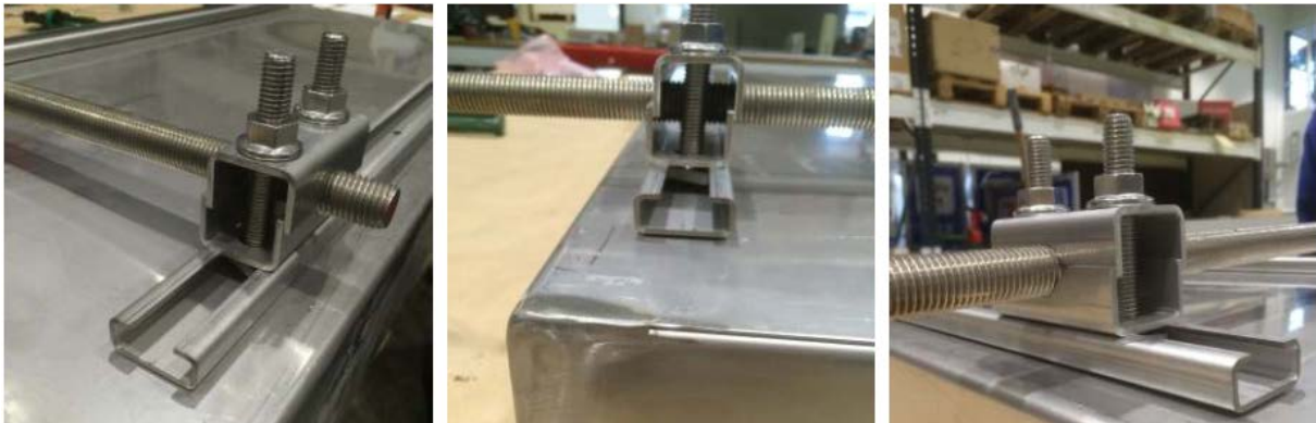
Figur 5-1: Påmontert C-skinne forenkler montering av festeutstyr etter ønske og behov.
