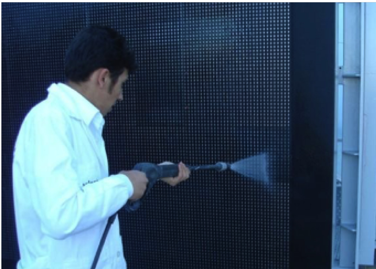
Figur 2: Rengjøring av front-enhetsplaten med vannstråle
