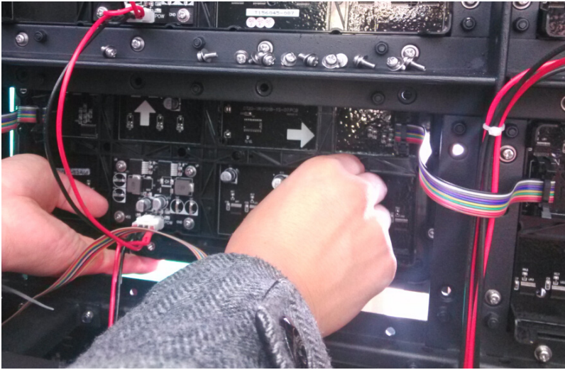
Figur 13: Skyv modulen ut av kabinettet
